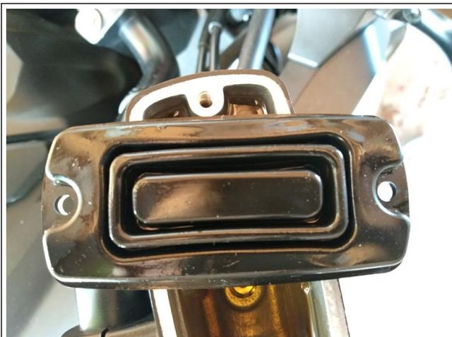
7. Répéter l'étape 5 afin d'évacuer le liquide de frein usagé contenu dans le circuit. Remplir le réservoir jusqu'au niveau haut (jusqu'à environ 5mm sous le bord). Nettoyer le joint et la portée du joint
