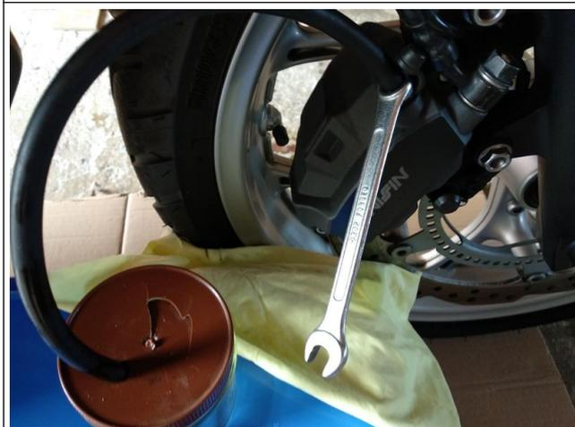
5. Ouvrir la vis de purge avec la clé à œil de 8mm, appuyer sur le levier du frein avant, fermer sans forcer la vis de purge (afin de ne pas insérer d'air dans le circuit par aspiration), puis relâcher le levier de frein avant
