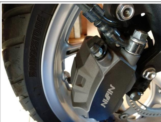
2. Au niveau de l'étrier de frein avant, placer un chiffon sous l'étrier, enlever le capuchon placé sur la vis de purge, placer la clé à œil de 8 mm, la durite et le bocal de collecte
