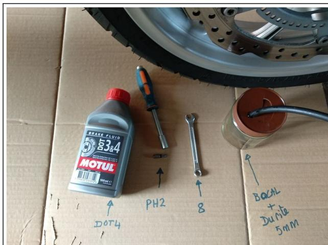
1. Prévoir un carton, un chiffon, une clé à œil de 8 mm, un tournevis doté d'une empreinte PH2, un bidon **non ouvert** de liquide de frein DOT4, un bocal et une durite pour la collecte du liquide de frein usagé
