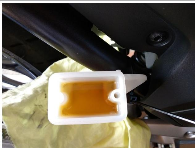
16. Répéter l'étape 15 jusqu'à ce que le réservoir soit **presque** vide afin de ne pas insérer d'air dans le circuit. Puis remplir le réservoir de liquide de frein DOT 4
