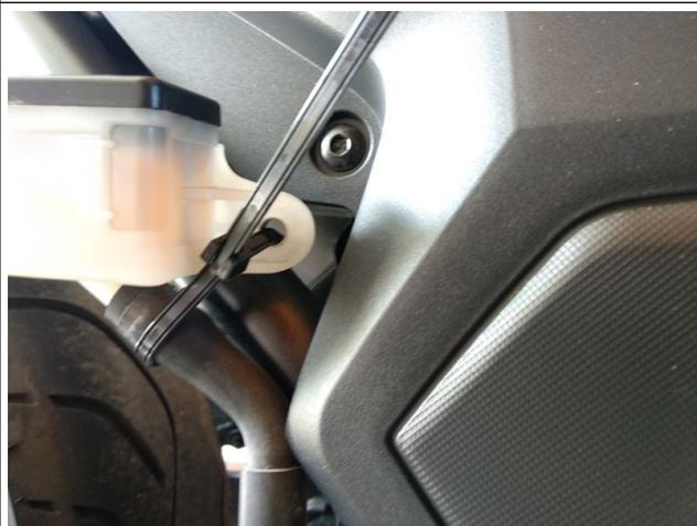
12. Déplacer le réservoir vers vous et le fixer au châssis à l'aide d'un collier
