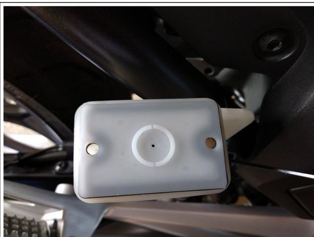
14. Enlever les 2 vis du couvercle du réservoir à l'aide d'un tournevis doté d'une empreinte PH2. Au fur et à mesure du démontage, enlever à l'aide d'un chiffon et vers l'extérieur, d'éventuelles poussières.
