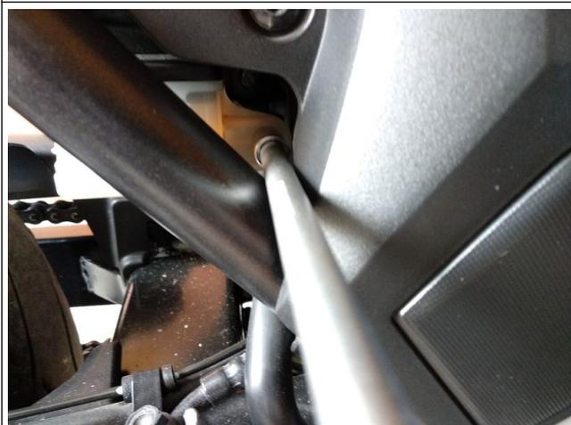
11. Enlever la vis de fixation du réservoir de liquide de frein arrière
