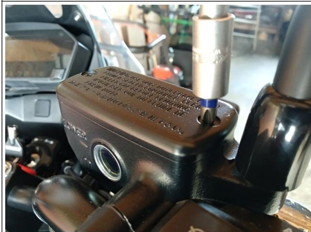
3. Enlever les 2 vis du couvercle du réservoir à l'aide d'un tournevis doté d'une empreinte PH2
