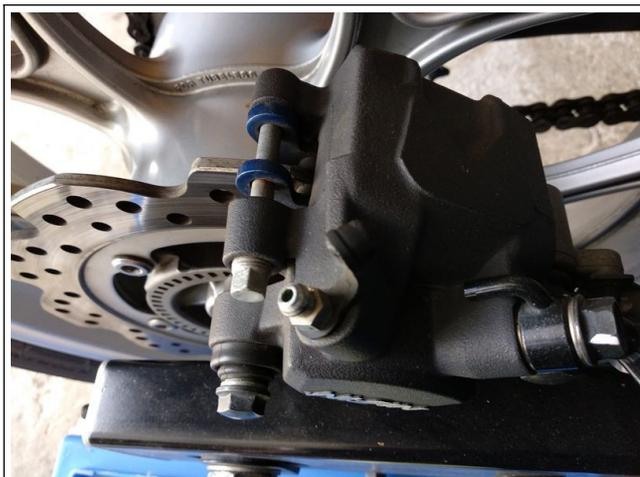
13. Au niveau de l'étrier de frein arrière, placer un chiffon sous l'étrier, enlever le capuchon placé sur la vis de purge, placer la clé à œil de 8 mm, la durite et le bocal de collecte
