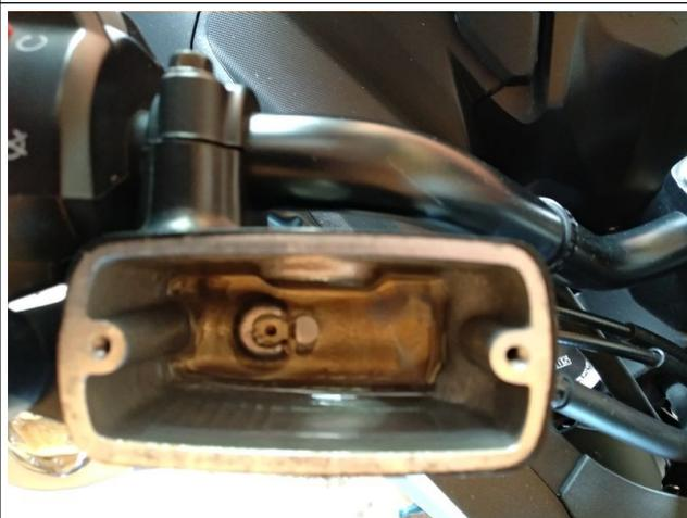
6. Répéter l'étape 5 jusqu'à ce que le réservoir soit **presque** vide afin de ne pas insérer d'air dans le circuit. Puis remplir le réservoir de liquide de frein DOT 4
