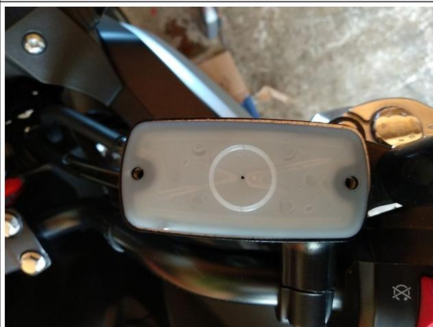
4. Au fur et à mesure du démontage, enlever à l'aide d'un chiffon et vers l'extérieur, d'éventuelles poussières
