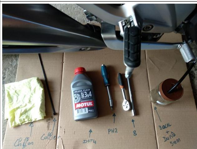
10. Pour la purge du frein arrière, prévoir en plus de l'étape n°1 un collier et une clé à douille de 8 mm
