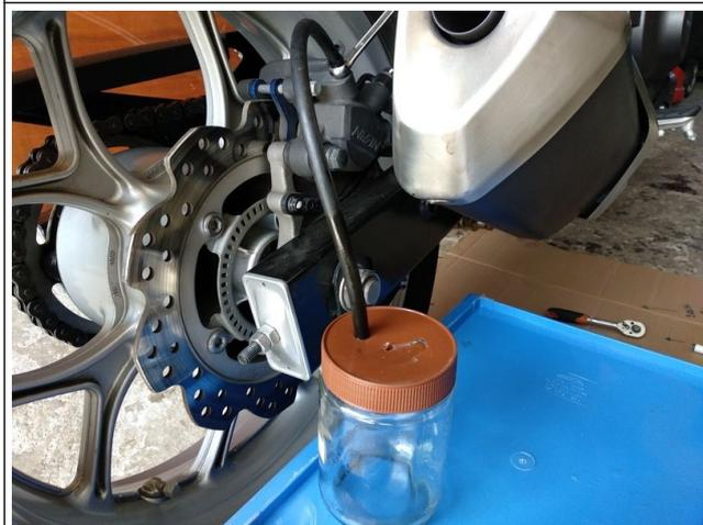
15. Ouvrir la vis de purge avec la clé à œil de 8mm, appuyer sur la pédale du frein arrière, fermer sans forcer la vis de purge (afin de ne pas insérer d'air dans le circuit par aspiration), puis relâcher la pédale de frein arrière
