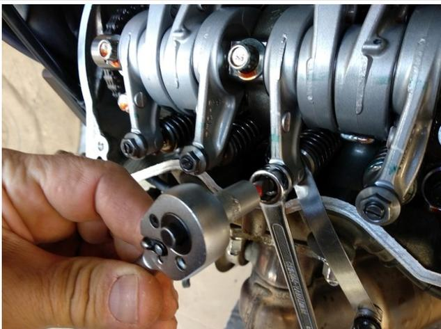
22. Si besoin, débloquer la vis à l'aide d'une clé à œil et ajuster le jeu à l'aide d'un tournevis. Utiliser les bonnes empreintes et rester bien dans l'axe afin d'éviter tout risque mécanique. Ensuite, bloquer légèrement la vis à l'aide d'une clé plate à œil en
