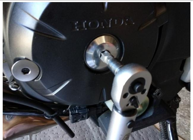
26. Mettre en place le cache culbuteurs. Avancer les trois vis (et les joints) manuellement puis procéder au serrage uniforme des trois vis au couple de 4 Nm à l'aide d'un clé dynamométrique
