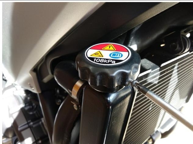
4. Enlever la vis de blocage du bouchon du radiateur
