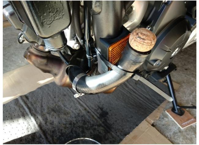
7. Nettoyer les projections au sol. Attacher la durite au cadre à l'aide d'un collier réutilisable. Boucher la durite à l'aide d'un bouchon
