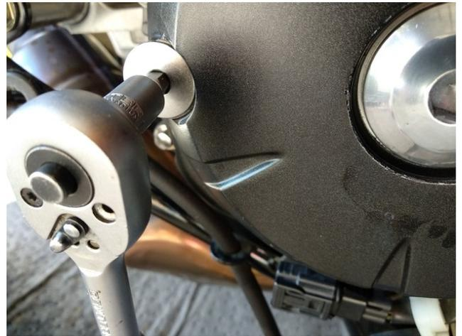
16. Enlever les deux caches situés à gauche du vilebrequin moteur. Utiliser les bonnes empreintes et rester bien dans l'axe afin d'éviter tout risque mécanique. Veiller à collecter les joints. Nettoyer la portée des joints
