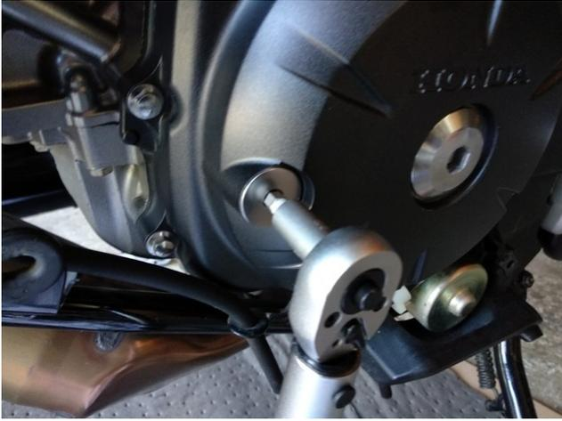
27. Mettre en place le second cache et son joint. Utiliser les bonnes empreintes et rester bien dans l'axe afin d'éviter tout risque mécanique. Avancer la vis manuellement puis procéder au serrage final au couple de 10 Nm à l'aide d'un clé dynamométrique
