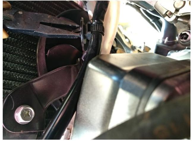
12. Dégrafer la prise électrique du ventilateur de son support. Dégrafer également le tuyau transparent et le câble électrique noir, lesquels sont fixés au radiateur
