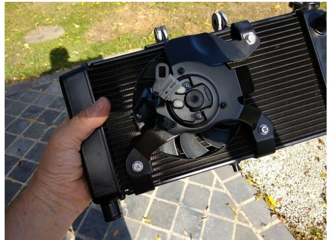
14. Profitez de l'occasion pour nettoyer le radiateur à l'aide d'un compresseur et redresser les ailettes à l'aide d'un petit tournevis si besoin
