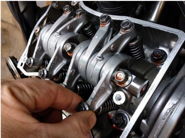
20. Tester manuellement le jeu au niveau des culbuteurs d'admission et d'échappement du cylindre n°1 (celui qui est situé sur le côté gauche de la moto). S'il n'y a pas de jeu, tourner le vilebrequin d'un tour dans le sens anti-horaire (voir photo n°19) jusqu'à la marque T1
