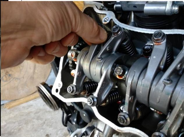
24. Tourner le vilebrequin dans le sens anti-horaire jusqu'à obtenir la marque T2. Tester manuellement le jeu au niveau des culbuteurs d'admission et d'échappement du cylindre n°2 (celui qui est situé sur le côté droit de la moto). S'il n'y a pas de jeu, tourner le vilebrequin d'un tour dans le sens anti-horaire jusqu'à la marque T2. Contrôler et ajuster le jeu aux soupapes d'admission et d'échappement en répétant les opérations n°20 à n°23 pour le cylindre n°2
