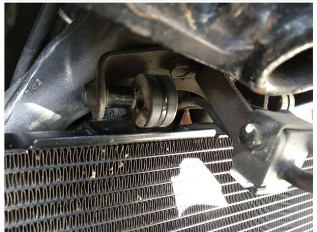
11. Pousser le radiateur vers le côté gauche afin de le déposer
