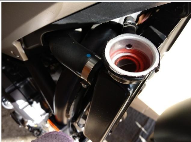
5. Enlever le bouchon du radiateur et si possible aspirer et collecter le liquide de refroidissement
