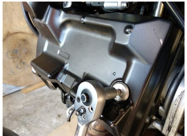
17. Enlever la durite de mise à l'air du cache culbuteur. Enlever les trois vis du cache culbuteurs. Utiliser les bonnes empreintes et rester bien dans l'axe afin d'éviter tout risque mécanique. Veiller à collecter les joints
