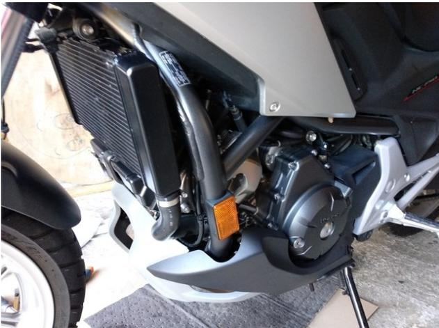
29. Remettre en place le sabot moteur. Démarrer le moteur et contrôler l'absence de fuite au niveau des durites.
