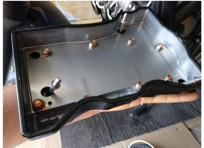
25. Nettoyer le joint et la portée du joint du cache culbuteurs. Déposer un film d'huile moteur sur le joint avant repose du cache culbuteurs
