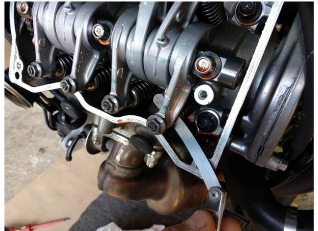
21. Contrôler le jeu des soupapes d'échappement et d'admission du cylindre n°1 à l'aide de cales d'épaisseur. Le jeu doit être « gras » avec une épaisseur de 0.28 mm pour l'échappement et 0.17 mm pour l'admission
