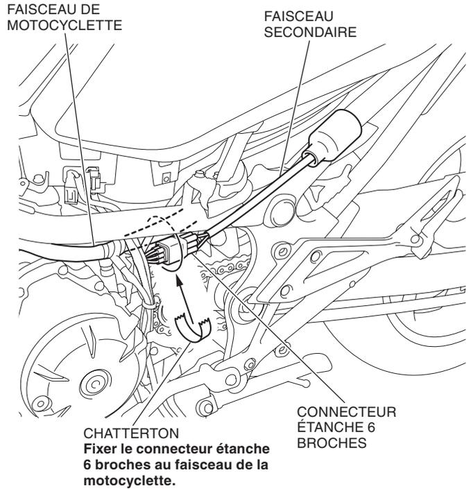
25. Se reporter au mode d'emploi du système de navigation, et connecter les câbles d'alimentation au faisceau secondaire.
