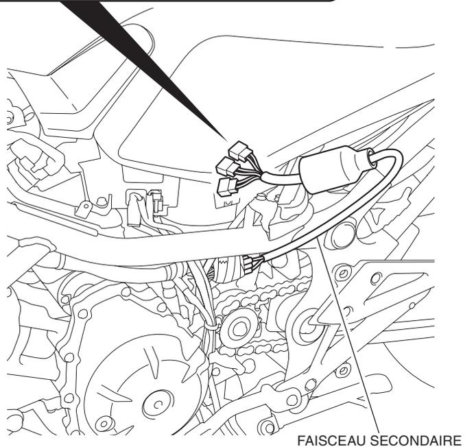
26. Fixer chaque faisceau du système de navigation avec le serre-fils, si nécessaire.
