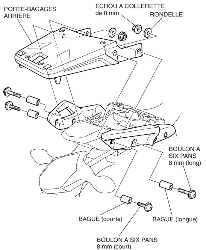
7. Serrez complètement tout le matériel de fixation partiellement serré selon les spécifications indiquées dans le tableau des couples. Posez les bouchons de la manière indiquée.
