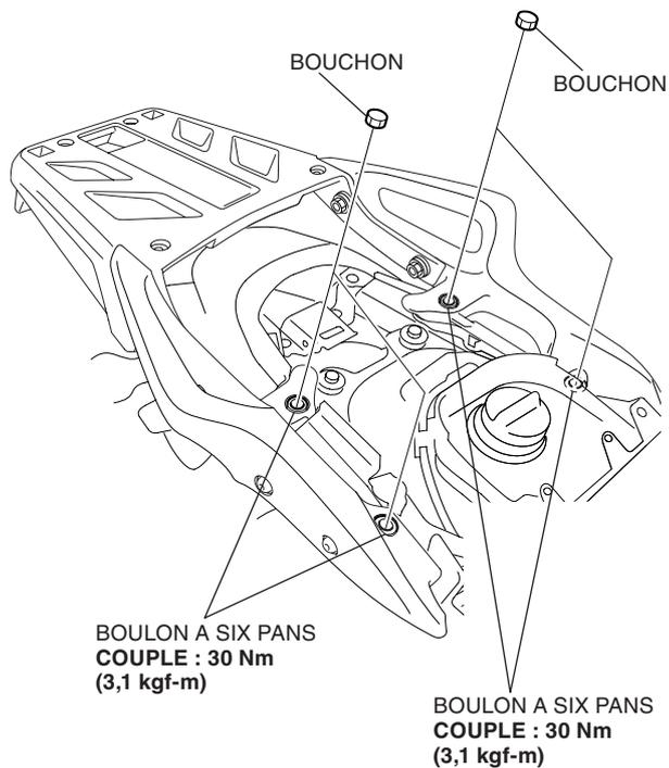
6. Montez les pièces retirées dans l'ordre inverse de la dépose.
