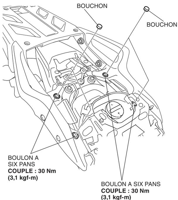
8. Montez les pièces retirées dans l'ordre inverse de la dépose.
