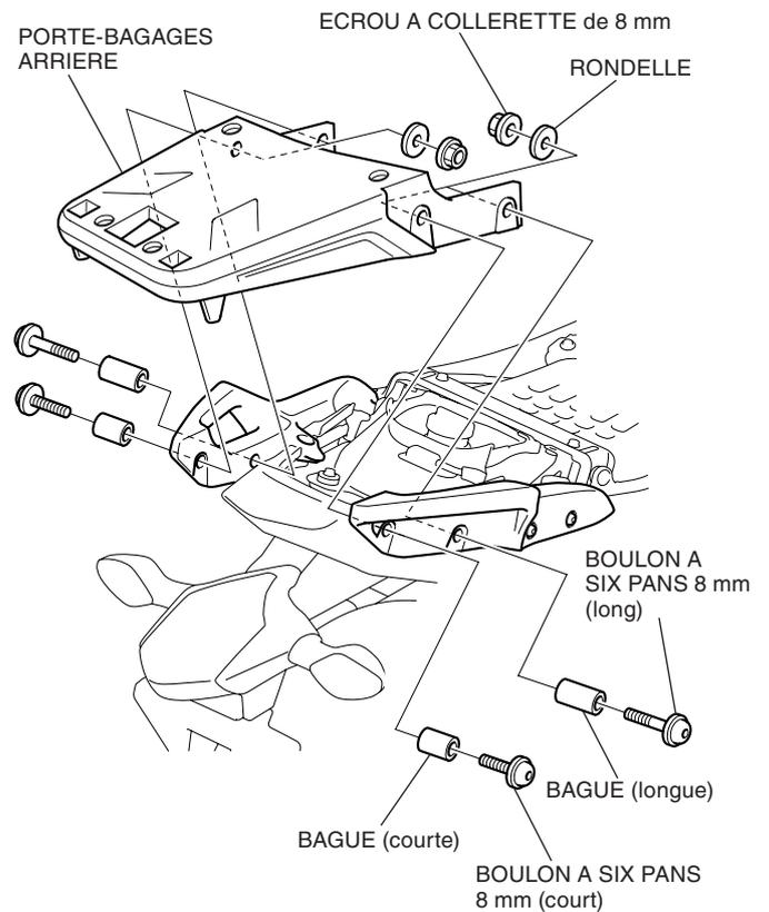
5. Serrez complètement tout le matériel de fixation partiellement serré selon les spécifications indiquées dans le tableau des couples. Posez les bouchons de la manière indiquée.
