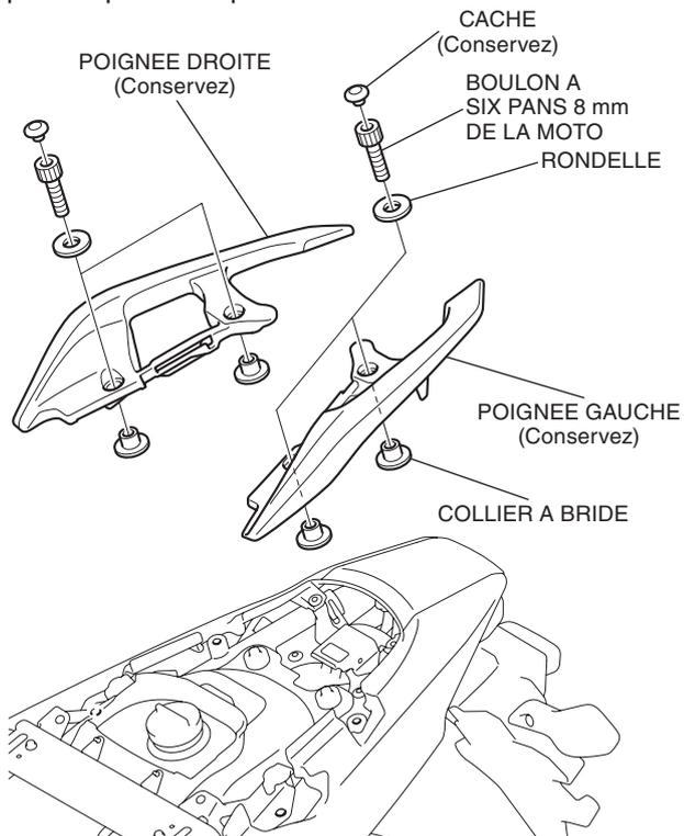
3. Installez les boulons à six pans de 8 mm et les écrous à collerette comme illustré.
