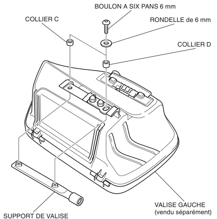
8. Montez la valise gauche et serrez complètement tout le matériel de fixation partiellement serré selon les spécifications indiquées dans le tableau des couples.
