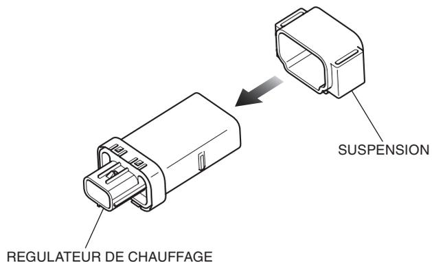
37. Connectez et fixez le régulateur de chauffage avec le serre-fils de la manière indiquée.
