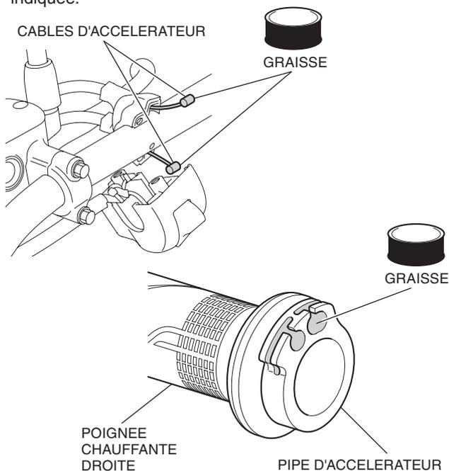
20. Montez la poignée chauffante droite et le contacteur de guidon dans l'ordre inverse de la dépose de la poignée de la moto.
