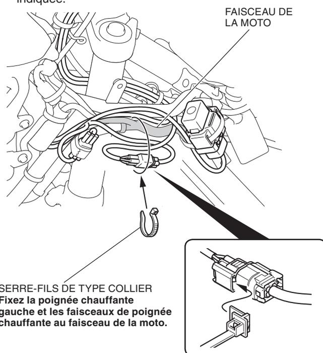
39. Vérifiez que chaque faisceau dispose d'un jeu suffisant.
