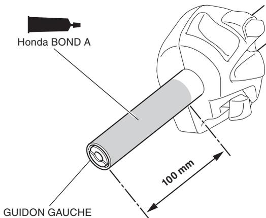
9. Pulvérisiez de l'alcool isopropylique sur l'intérieur de la poignée chauffante gauche et l'extérieur du guidon gauche.
