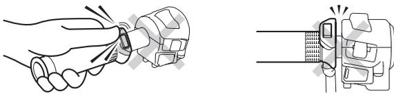
• Pendant l'installation, si la poignée se bloque, appliquez de l'alcool isopropylique dans l'interstice entre le contacteur et la poignée chauffante. N'essayez pas de déposer la poignée chauffante par la force ou en utilisant un tournevis, etc. Vous risqueriez d'endommager le fil de la poignée chauffante.
