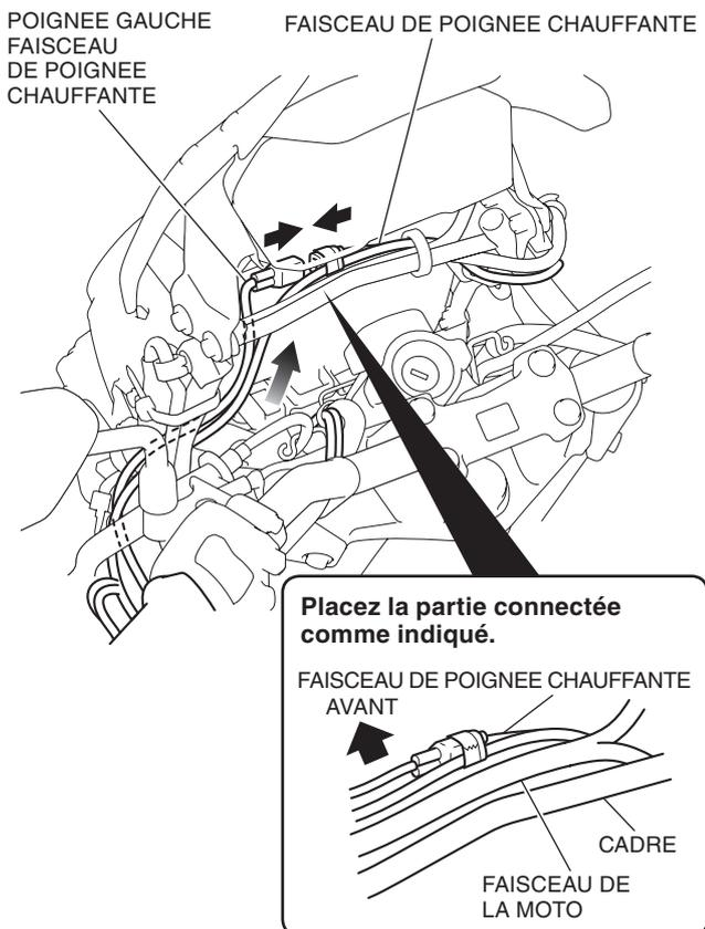
32. Fixez le faisceau de la poignée chauffante gauche et le faisceau de poignée chauffante à l'aide de serre-fils de la manière indiquée.
